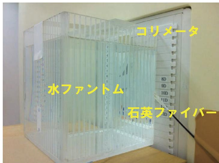
図6 水ファントム照射実験写真
