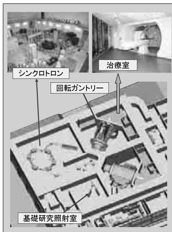
図2 筑波大学陽子線医学利用研究センターの配置図です。陽子線の初期加速に必要なリニアック、光の速度の6割まで加速するためのシンクロトロン、あらゆる角度から患者様に照射するための回転ガントリーからできています。
