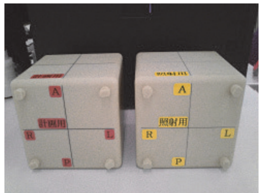
図1：郵送 IMRT ファントム。 (左) 計画用ファントム (右) 照射用ファントム。
