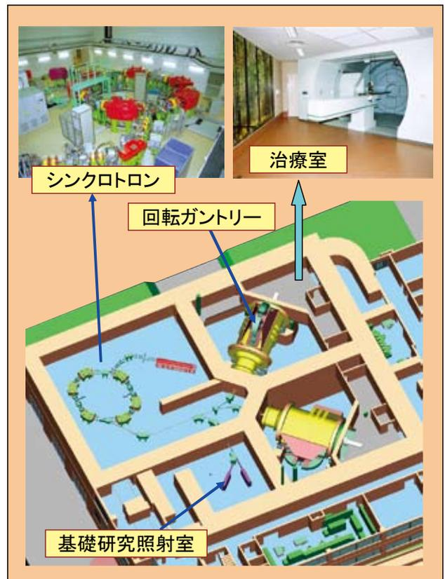
図2 筑波大学陽子線医学利用研究センターの配置図です。陽子線の初期加速に必要なリニアック、光の速度の6割まで加速するためのシンクロトロン、あらゆる角度から患者様に照射するための回旋ガントリーからできています。
