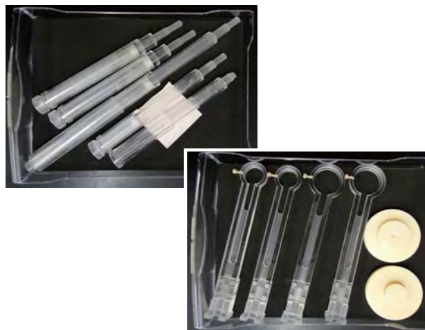
図 2 (上) 円筒形電離箱用防浸鞘 図 3 (下) 平行平板形電離箱用固定治具
