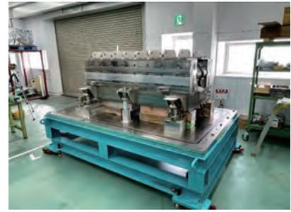
図5. 2021年6月に原理実証を実施した超伝導偏向電磁石の外観
