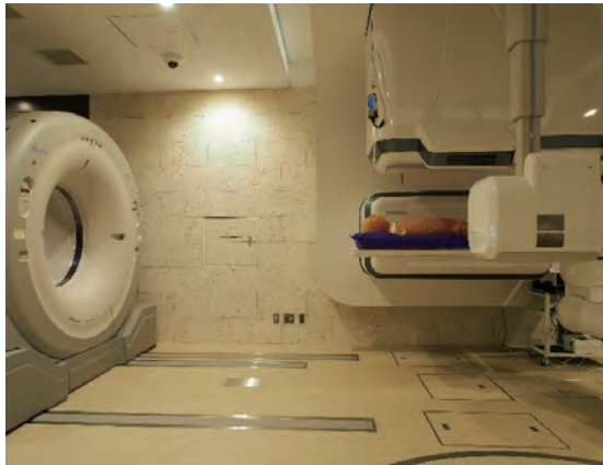
図4 in-room CT撮影（左：正面・側面のX線による骨照合，右：CT撮影）
