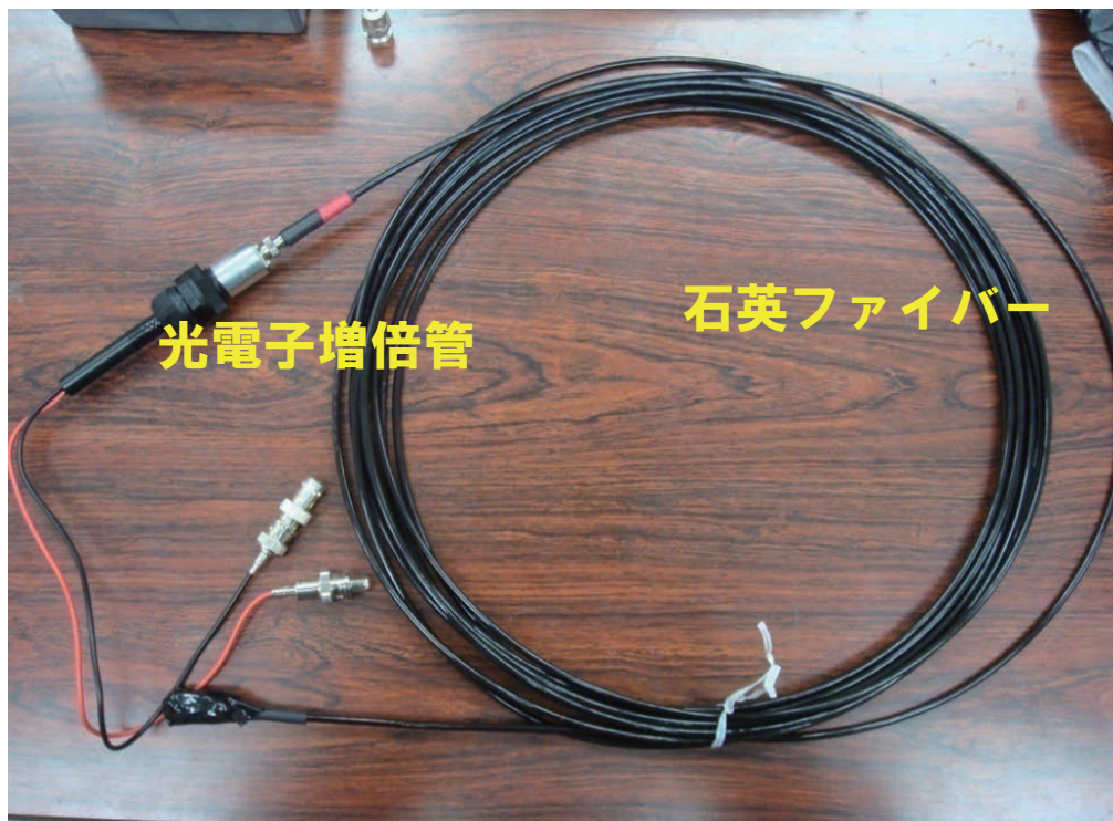
図4 石英ファイバーと有機シンチレータを組み合わせた高速中性子束モニタ
