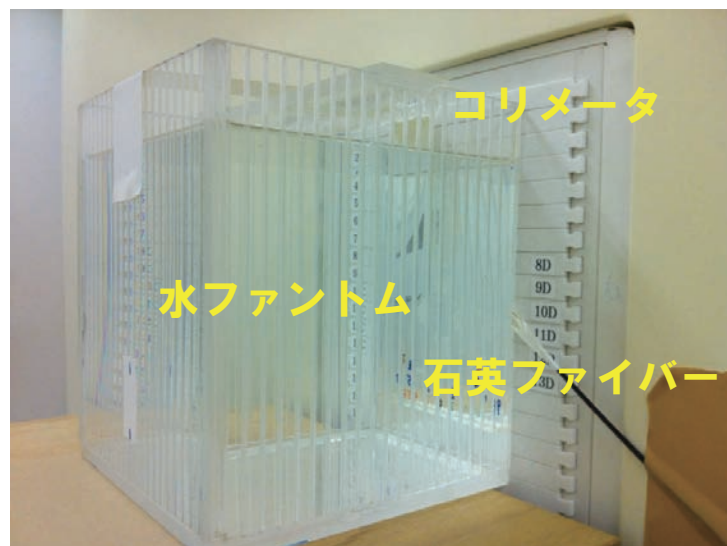
図6 水ファントム照射実験写真
